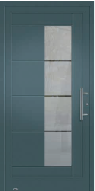
5314 Hier als Glasfalz-Füllung und mit Stoßgriff 5722.350 dargestellt. V: VSG mattiert mit klaren Streifen O: ca. RAL 7011 Eisengrau matt U p : 0,99
